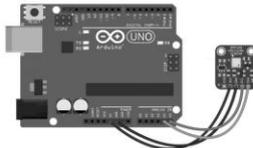
**Gambar 4.** Pemasangan sensor BMP 180 pada Arduino Uno
